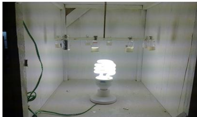
Gambar 7. Kotak cahaya untuk Fotoreduksi
