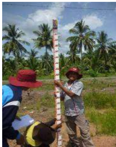
Gambar 3. Pembacaan papan pengukur ketinggian lahan
